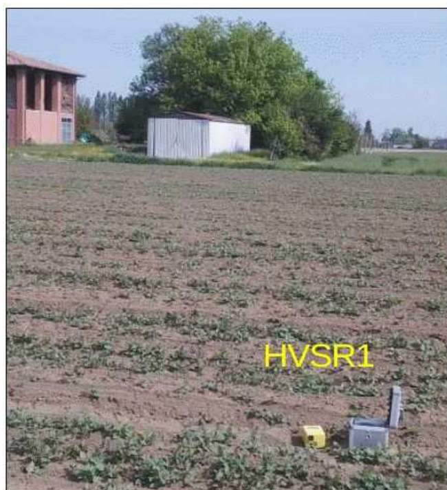
Foto 2.3 - Registrazioni sismiche HVSR eseguite per questo studio
