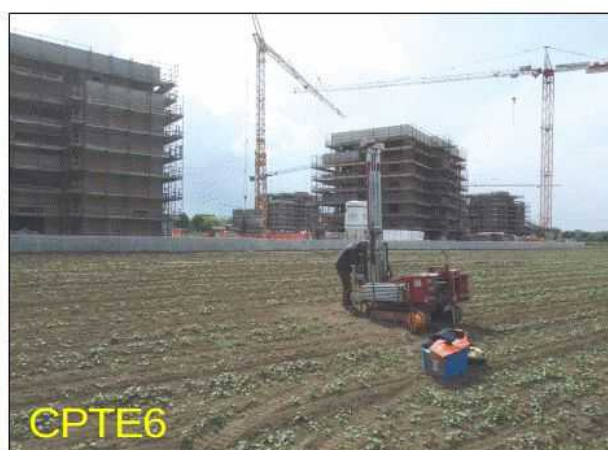
Foto 2.1 - Prove penetrometriche CPTU eseguite per questo studio
