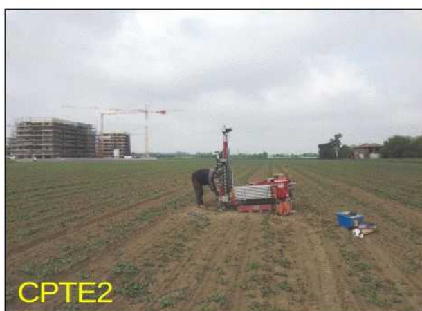
Foto 2.1 - Prove penetrometriche CPTU eseguite per questo studio
