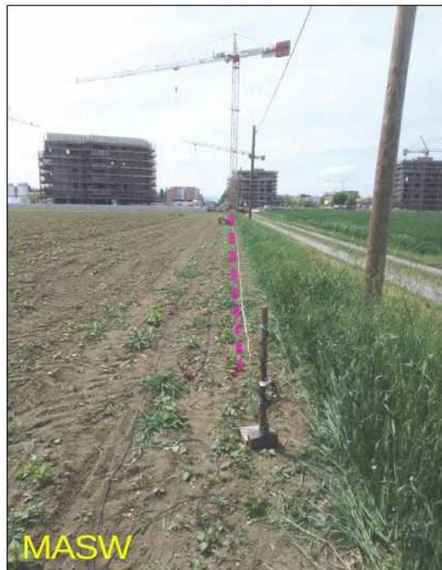
Foto 2.2 - Stendimento sismico MASW/ReMi eseguito per questo studio
