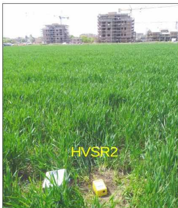
Foto 2.3 - Registrazioni sismiche HVSR eseguite per questo studio
